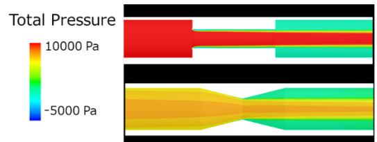
Fig. 15 CFDでチューブ型の狭窄、テーパ型の狭窄を解析した例。テーパ型は Total Pressure の損失が小さい。 14
